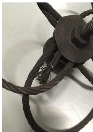
Obr. 7 a 8 Upravený kominický strojek pomocí ocelového lanka
