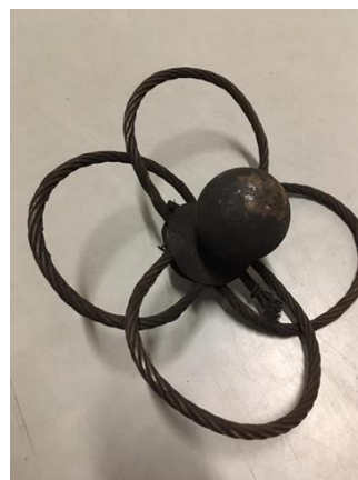
Obr. 7 a 8 Upravený kominický strojek pomocí ocelového lanka
