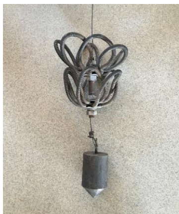
Obr. 6 Zdeformovaný kominický strojek
