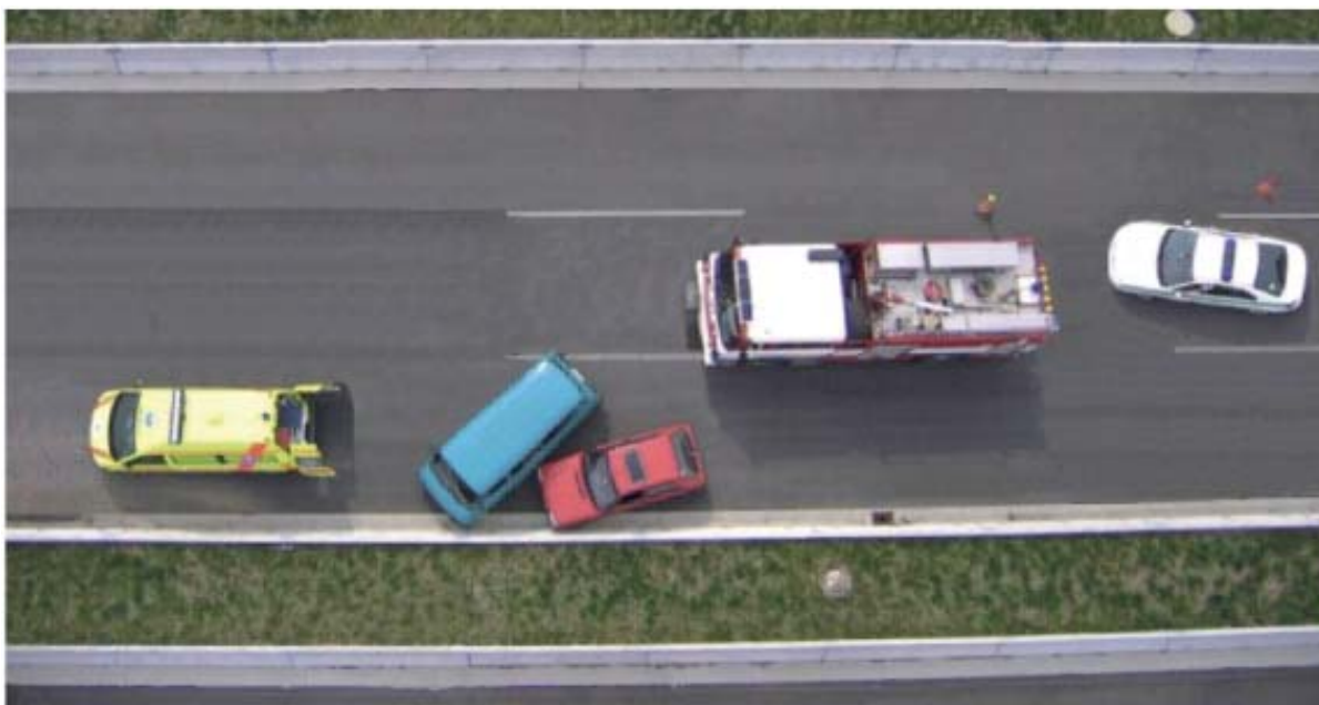
Obr. 9 Varianta 3A, při využití všech dostupných prostředků (mobilní technika složek IZS, výstražné kužele a směrové desky)
