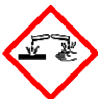
GHS05 korozivní a žíravé látky
